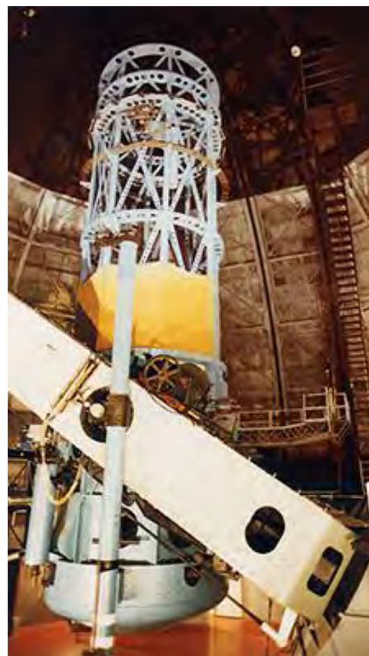
Télescope de Hooker (2,5 m) sur monture anglaise
