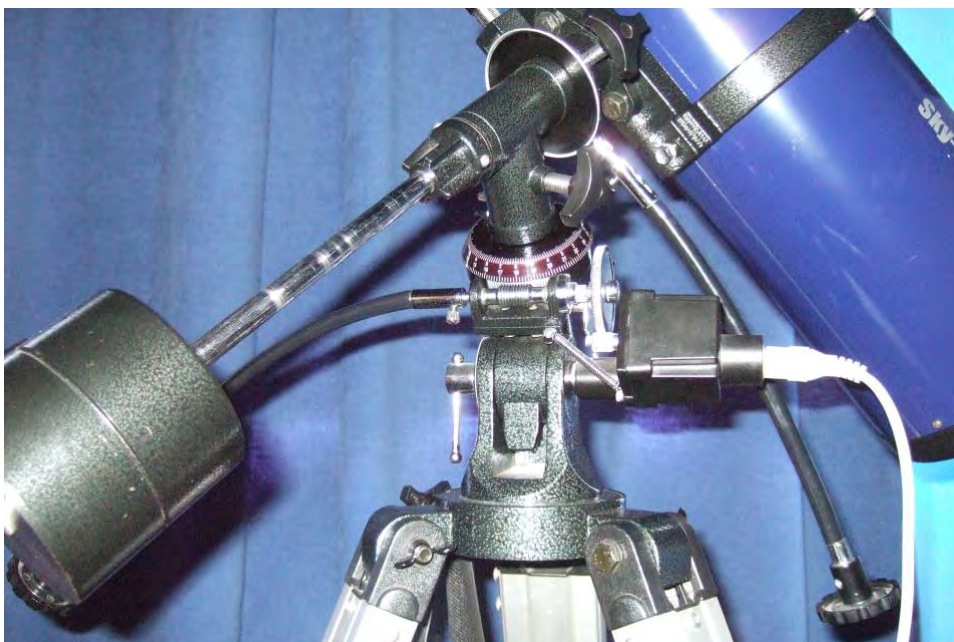
Une monture équatoriale type EQ-2 équipée d'un moteur sur un axe
