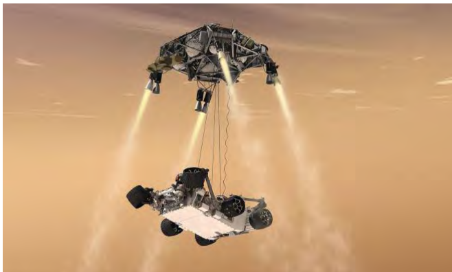
L'étage de descente, en vol statique, grute le rover jusqu'au sol
