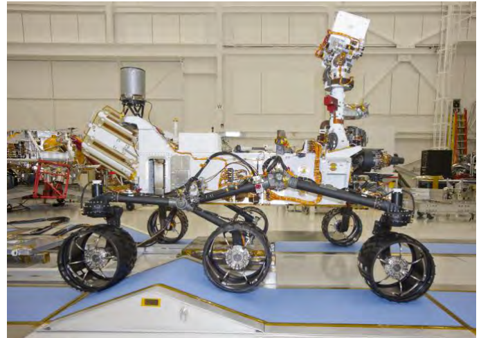
Curiosity utilise la suspension rocker bogie des rovers MER avec des roues d'un diamètre sensiblement accru
