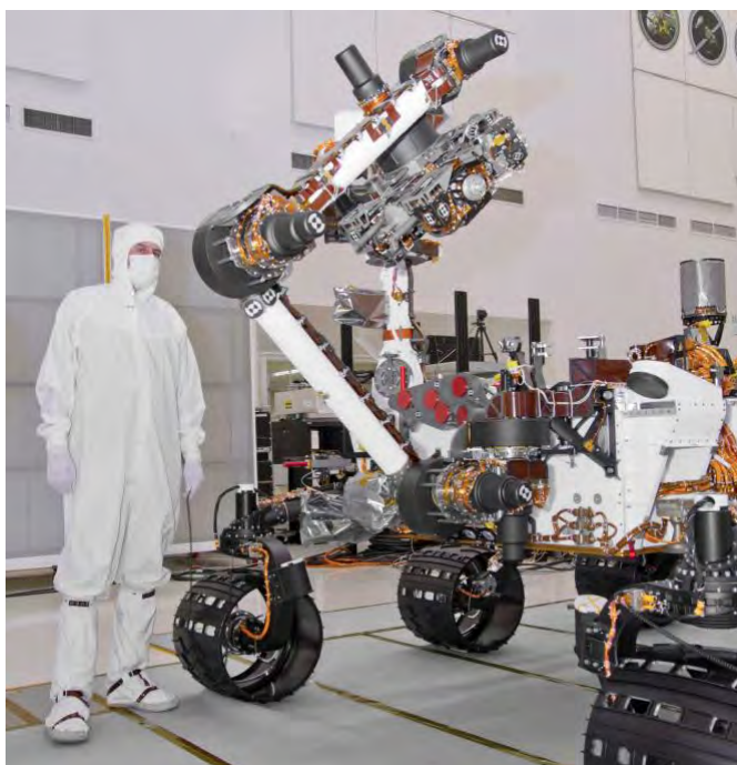
Le fonctionnement du bras porte-outils est testé en salle d'assemblage
