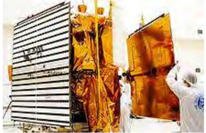
*Seule 30 % de la surface des panneaux solaires est recouverte de cellules solaires pour résister aux températures rencontrées*
