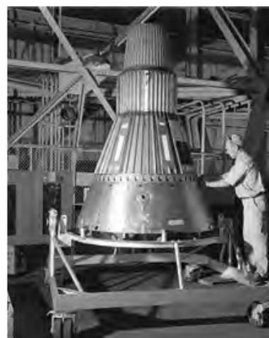
*La capsule Mercury en cours d'assemblage. La coque assurant la protection thermique n'a pas encore été mise en place*
