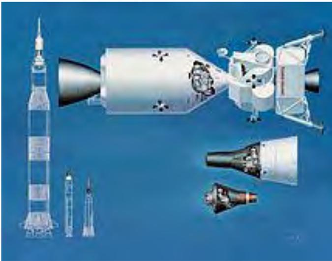
*La capsule Mercury est particulièrement compacte. Dans l'ordre de taille croissante figure vaisseau et lanceur des programmes Mercury, Gemini et Apollo*
