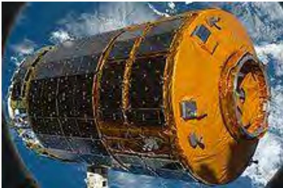
*Le vaisseau cargo japonais HTV vient d'être « capturé » par le bras robotique Canadarm2 manipulé depuis l'intérieur de la station spatiale*
