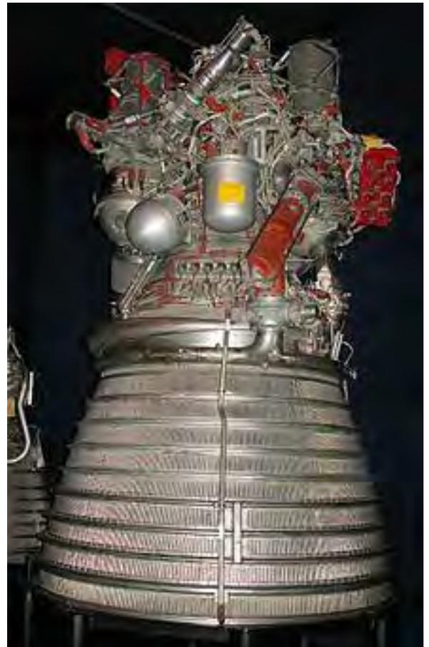
*Le moteur cryogénique J2 développé à compter de 1961 pour la propulsion des étages supérieurs de la fusée Saturn*
