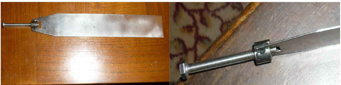
Le serrage sur la cage du secondaire se fera par un boulon dont l'écrou a été soudé par brasure sur la lame. La lame sera coupée à la bonne longueur lorsque le dimensionnement du diamètre de la cage du secondaire sera arrêté.
