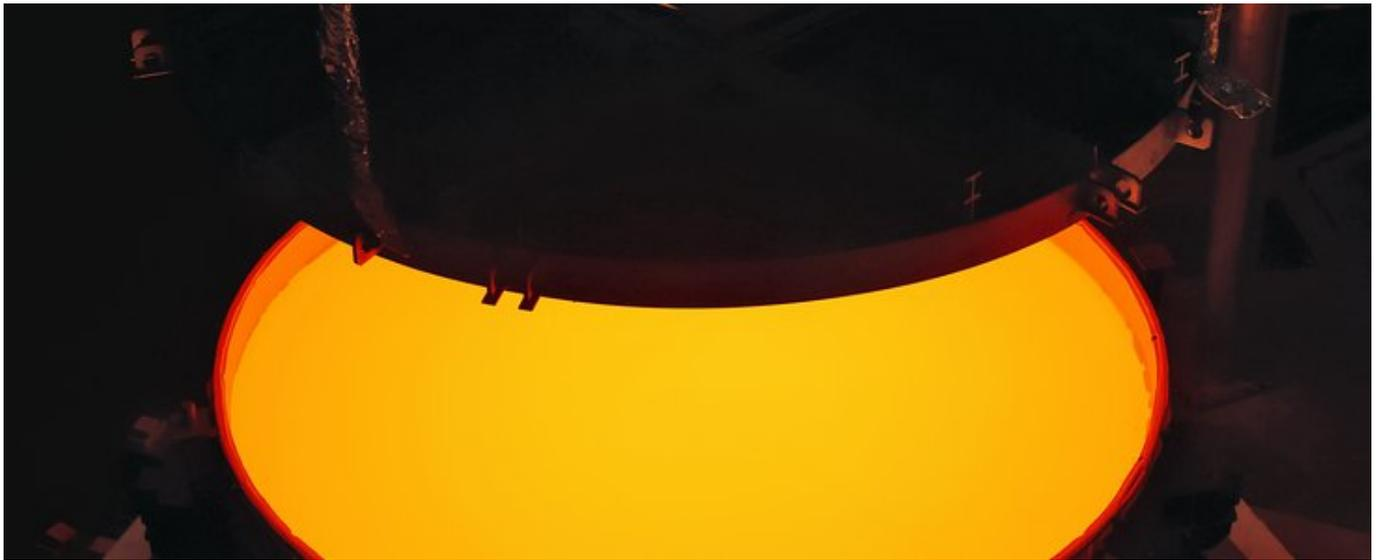
L'ébauche du miroir secondaire de l'ELT (télescope géant) a été réalisée par la société SCHOTT basée à Mayence en Allemagne. Lorsque finalisé, ce miroir sera caractérisé par un diamètre de 4,2 mètres et une masse de 3,5 tonnes. Il sera alors le plus grand miroir secondaire jamais installé sur un télescope ainsi que le plus grand miroir convexe réalisé à ce jour.
